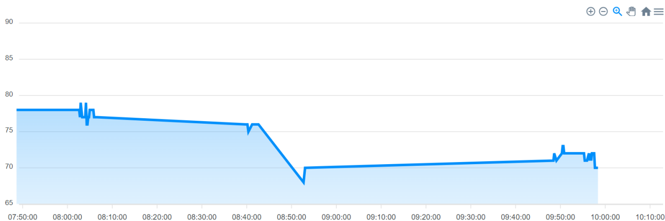
Рис.9. Пример графиков отслеживания загрузки ЦП и ОЗУ HMI контроллера станции
